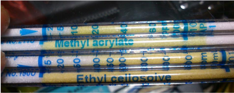
管が約 10ppm、セロソルブ用の検知管が 50ppm 以上と異常な数値を示すのに対し、その約 20 分後でほとんど反応を示さなくなることからわかります。写真 3 では、上側の 2 本がアクリル酸メチル用、下側の 2 本がセロソルブ用の検知管であり、それぞれの上側が採取開始時、下側
